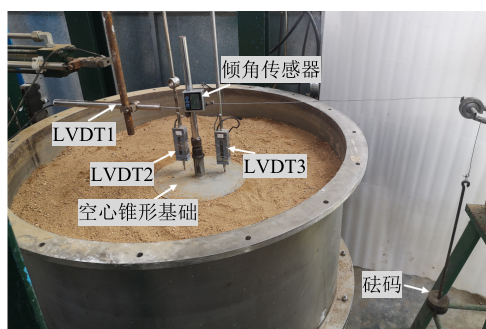
图 3 模型试验箱 Fig.3 Model tests tank
